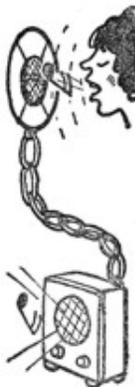
**Rad.** —Eso no es del todo exacto. El micrófono (figura 35) se compone de una delgada membrana metálica separada por minúsculos granos de carbón de una caja metálica. La corriente de una batería pasa de la membrana a la caja a través de los granos de carbón. La intensidad de esa corriente depende evidentemente de la resistencia del carbón. Ella varía de acuerdo con la presión ejercida sobre la membrana.
