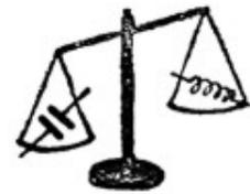
**Cur.** — No. En el filtro a capacitancia, aumentando la frecuencia, disminuye aquélla; el acoplamiento es menor y la banda pasante se vuelve más estrecha. En el filtro por inductancia, ésta aumenta con la frecuencia, y, por consiguiente, la banda pasante se abre.
