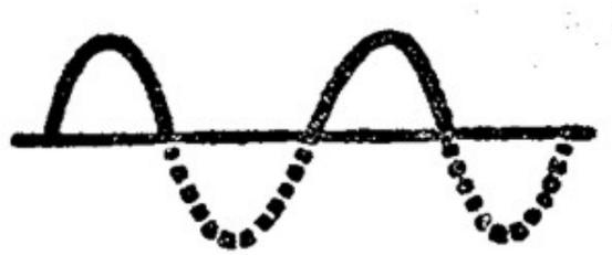
Figura 80. — La corriente rectificada con los dispositivos de las figuras 78 y 79 aparece en trazo lleno. El trazo punteado forma las alternancias no rectificadas
