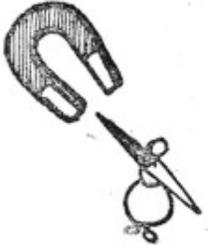
**Rad.** — Sí. De modo que si para una corriente dada, un polo del electroimán atrae el polo norte de la aguja, al invertir el sentido de la corriente, ese mismo polo atraerá entonces el sur; porque el campo magnético tiene un sentido que depende de la dirección de la corriente que lo crea. Y cada variación del sentido o de la intensidad de la misma se traduce en una variación del campo magnético.
